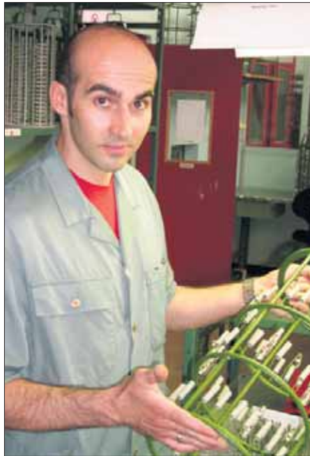
José-Luis Lopez. Avec un lot de pièces de stylo sur le support qui permettra de les plonger dans le bain d'électrolyte. (DR)
